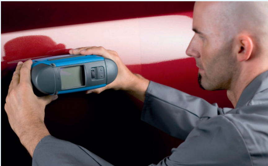
Bild 2. BYK-mac im Einsatz am Fahrzeug (Foto: Byk-Gardner)
