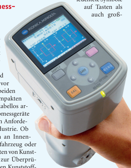
Bild 6. Handliches und erstes kabelfreies Farbmessgerät CM700d (Foto: Konica Minolta)
