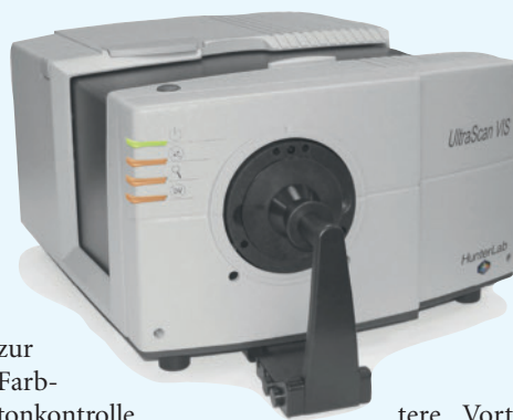
Bild 8. Ultra-Scan VIS Farbmessung nach neuer ASTM-Richtlinie im Labor (Foto: Hunter-Lab)
