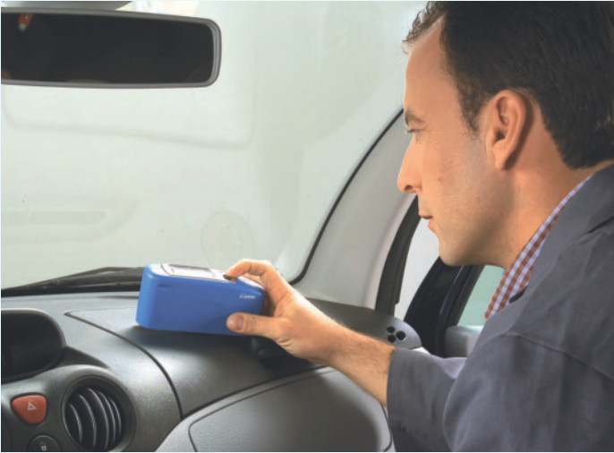
Bild 4. Neues Glanzmessgerät zur 60°-Messung extrem matter Oberflächen im Fahrzeug (Foto: Byk-Gardner)
