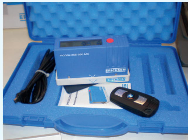
Bild 5. Mini Glanzmessgerät Picogloss 562 MC (Foto: Schröder)
