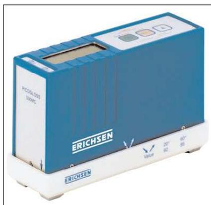
Abbildung 2: 2 Winkelglanzmessgerät ( 20°/60°) von Erichsen
