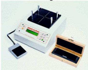
Abbildung 4: NOVO Curve von Rhopoint zur Glanzmessung im Labor an gekrümmten Oberflächen
