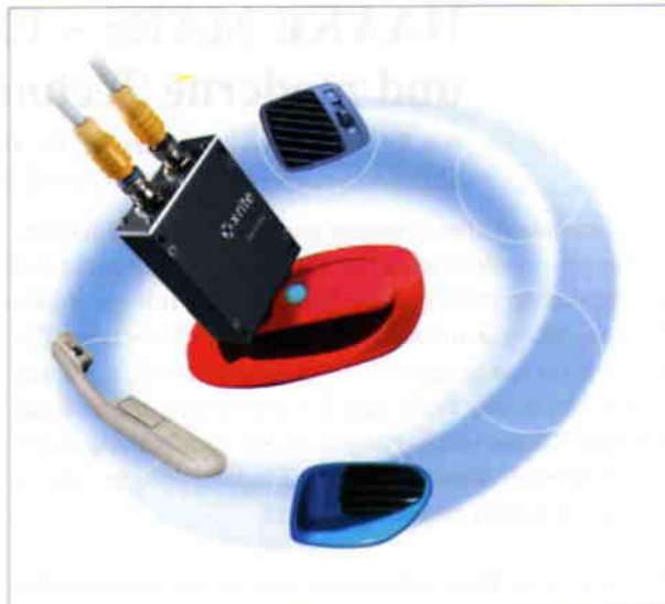
Abbildung 13: Farbsortierung mit spektralem Meßsensor (X-Rite)
