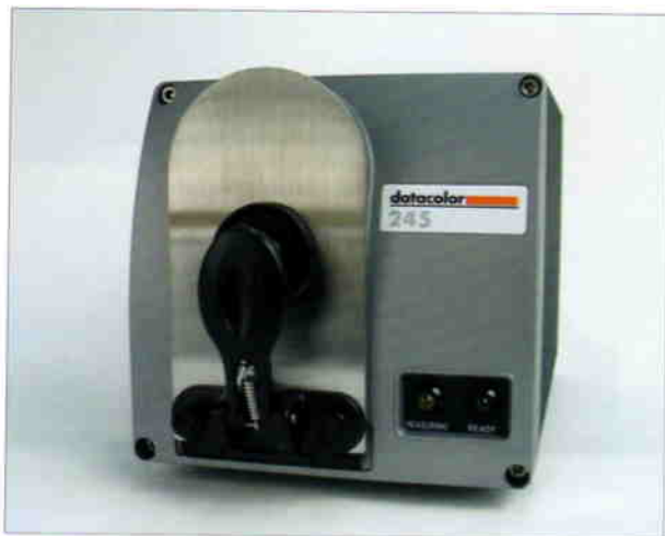
Abbildung 9: 45°/0°-Farbmessung mit datacolor 245
